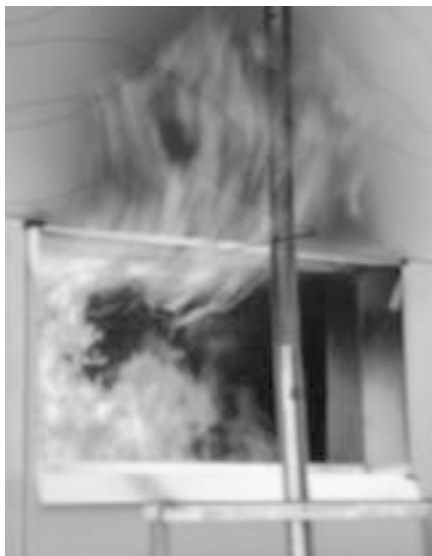
Рис. 4. Фрагмент огневых испытаний навесной фасадной системы «ФиброФасад»
